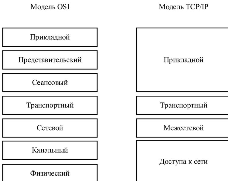
Рисунок 2.1.4 – Модели OSI и TCP/IP
