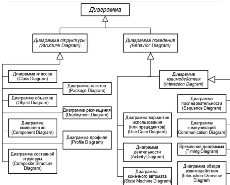
Рисунок 1.8.2 - Классификация моделей систем, применяемая в языке UML
