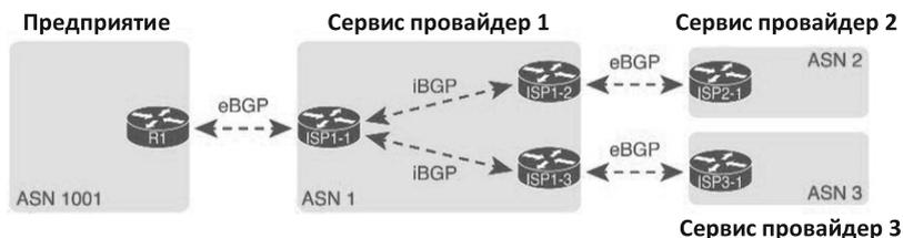
Рисунок 2.10.14 – Использование протоколов eBGP и iBGP
